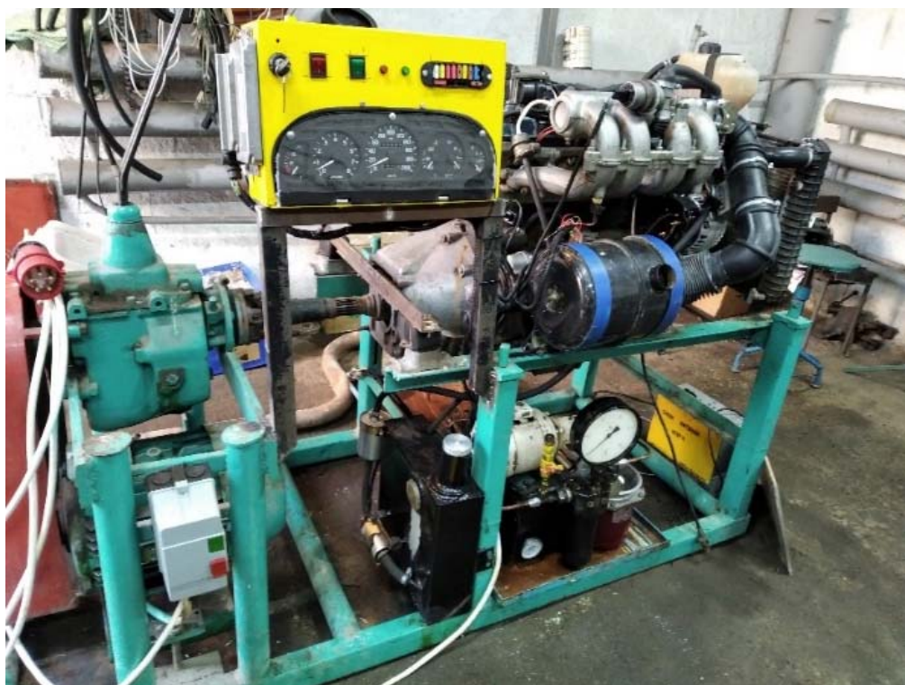
Рисунок 1 – Установка с возможностью доступа к впускной системе и выводам ДМРВ
