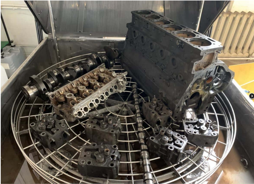
Рисунок 3 - Мойка деталей ДВС массой до 400 кг.
