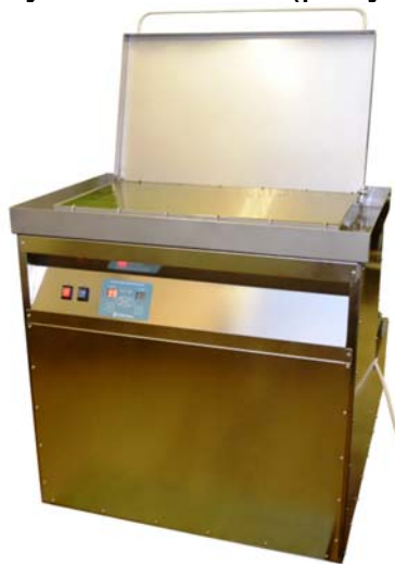
Рисунок 4 - Ультразвуковая ванна для чистки деталей (ПСБ-Галс ПСБ-120028-05)
