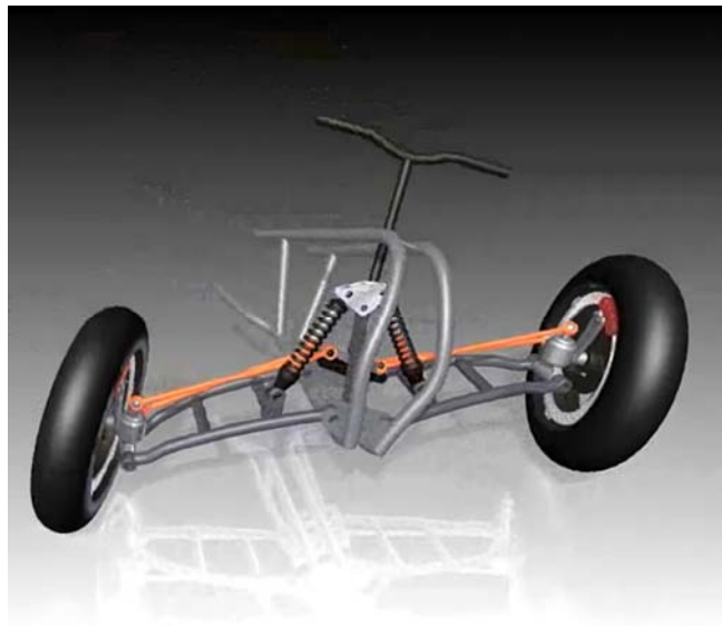
Рисунок 2 – Наклонный и поворотный механизм передних колес трайка
